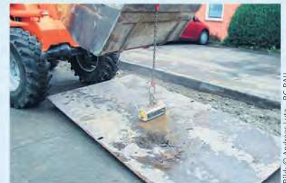
Lasthebemagnet mit Sicherheitsarretierung
