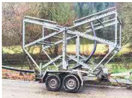
Ende der Rohrtrommel auf dem Abspulwagen kurz vor dem Herausschlagen
