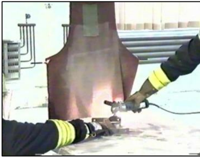
Bild 3: Funkenflug auf eine mit Magnesiumstaub behaftete Segeltuchschürze
