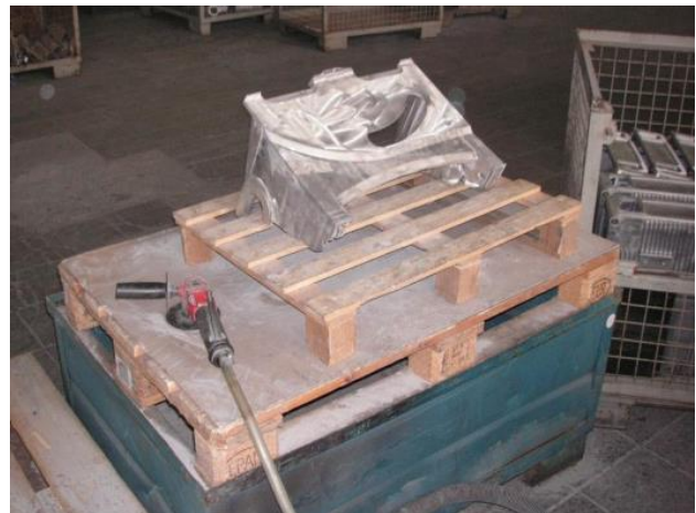
Bild 2: Ungeeigneter „improvisierter“ Schleifarbeitsplatz
