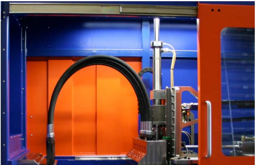
Abb. 3 Impuls-Prüfstand beim Schlauchleitungshersteller
