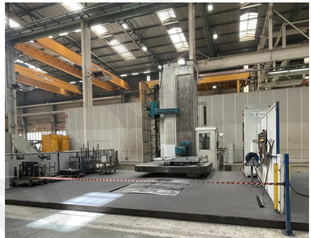
Abbildung 1 – Großzerspanungsmaschinen mit Zugangssicherung und gesichertem Bedienstand
