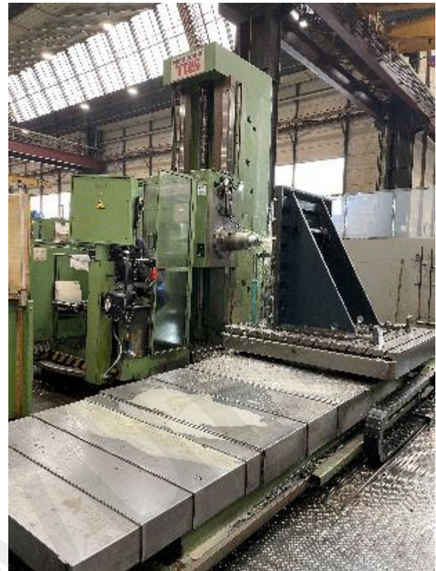
Abbildung 3 – Universalbohrwerk mit verriegelten beweglichen trennenden Schutzeinrichtungen am Bedienstand
