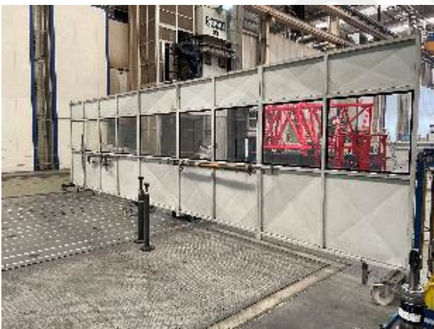
Abbildung 5 – Großzerspanungsmaschine mit Zugangsabsicherung durch eine bewegliche Stellwand, die in ihre Position steuerungstechnisch versiegelt werden kann
