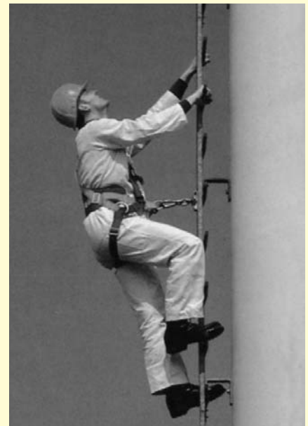
Abbildung 1: Mitlaufendes Auffanggerät einschließlich fester Führung (Schiene)
