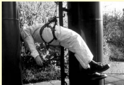
Abbildung 6: Ungünstige Hängeposition nach Auffangvorgang
