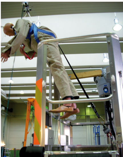
Bild 5 Versuchsanordnung Simulation Sturz beim Hinauslehnen.
