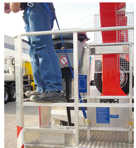
Bild 2 Nicht bestimmungsgemäßes Verwenden eines Rückhaltesystems.
