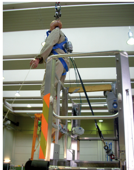
Bild 6 Versuchsanordnung Simulation Sturz beim Übersteigen.
