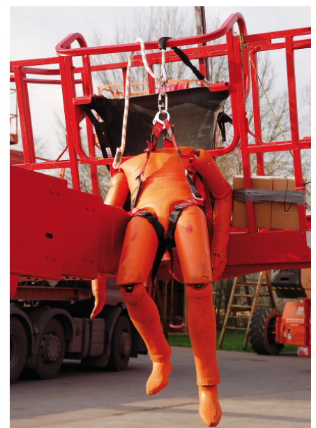
Bild 10 Simulation Herauskatapultieren des Dummies.
