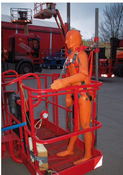
Bild 8 Simulation Sicherung durch Höhensicherungsgerät.
