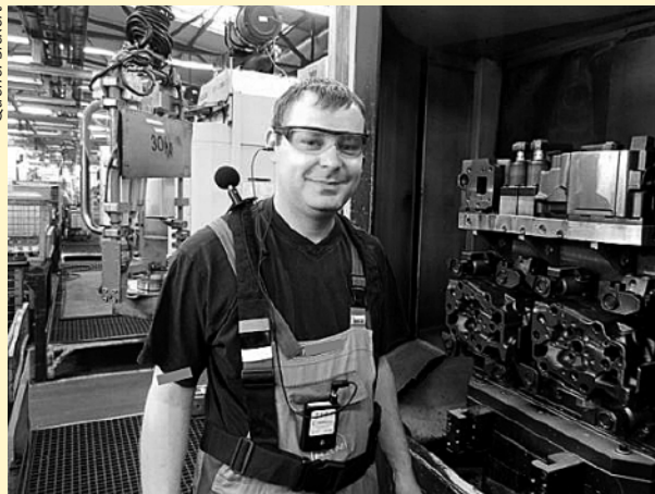
Abb. 2: Messung mit Personenschall-exposimeter (Lärmdosimeter) mit Mikrofonpositionierung auf der Schulter und ESP Dosimeter hinter dem Gehörschutz (Processor am Körper befestigt) an einer CNC-Bearbeitungsmaschine
