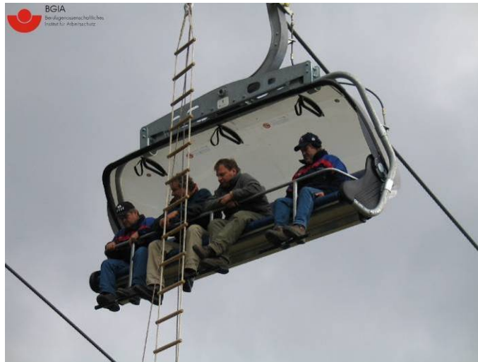
Abbildung 39: Seilbahntyp Rettungsversuche RV 31 und RV 33 (BGIA)
