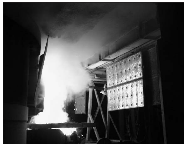
Bild 8 | Erschmelzen von Silizium – Freistechen mit Elektrolanze.
