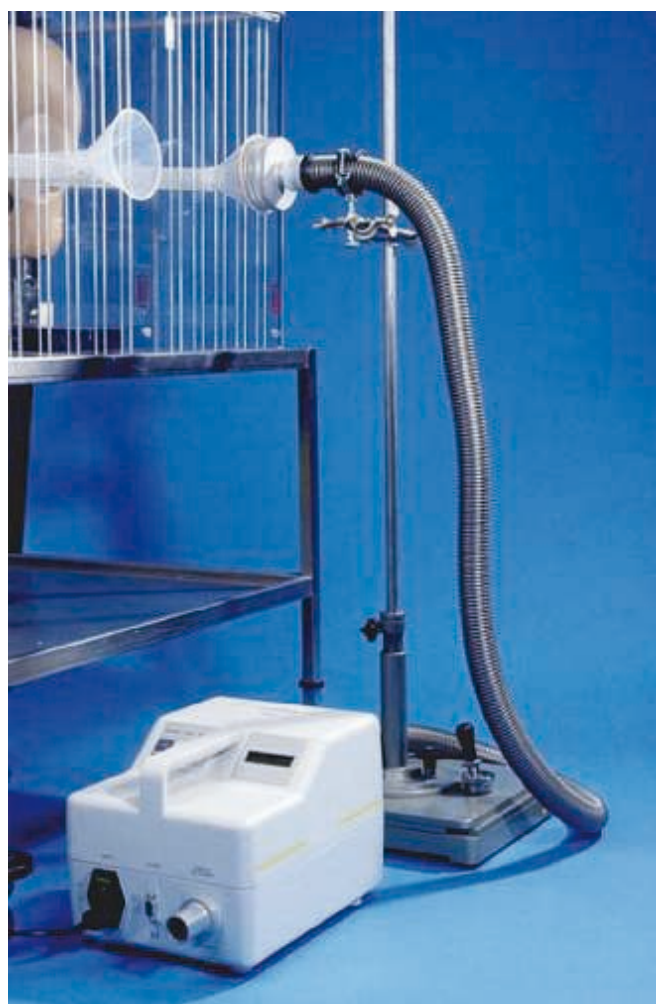
Bild 4. Keimrückgewinnung mittels eines Luftkeimsammlers MD 8 airscan der Fa. Sartorius (Göttingen).
