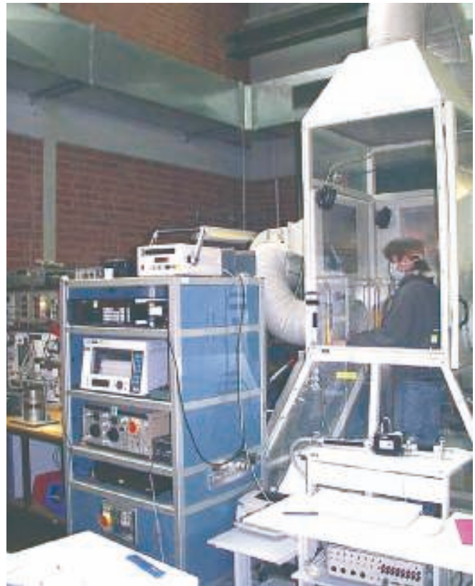
Bild 12. Prüfung von MNS in Anlehnung an DIN EN 149.
