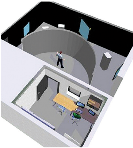
Bild 1 Modell des SUTAVE-Labors mit Interaktionsfläche und Präsentationsleinwand sowie Räumen für die Steuerung und Vorbereitung von Untersuchungen.
