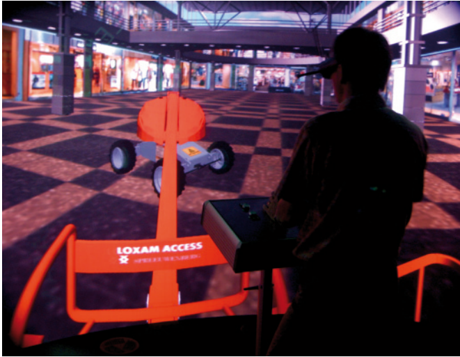
Bild 2 Benutzer einer virtuellen fahrbaren Hubarbeitsbühne mit realem Stellteil auf dem Weg zu seinem virtuellen Arbeitsplatz.
