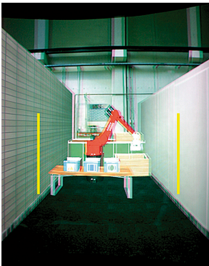
Bild 4 Virtuelle berührungslos wirkende Schutzeinrichtungen mit links zwei- und rechts dreidimensionalem Überwachungsbereich. Bilder 1 bis 4: IFA
