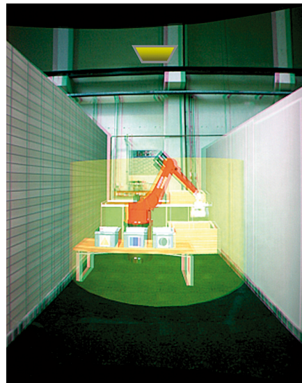
Bild 4 Virtuelle berührungslos wirkende Schutzeinrichtungen mit links zwei- und rechts dreidimensionalem Überwachungsbereich. Bilder 1 bis 4: IFA
