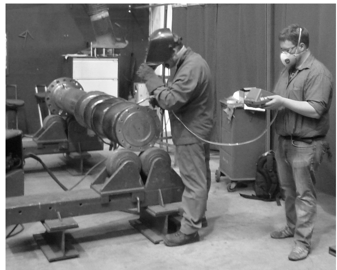
Bild 4. Messung am Schweißere Arbeitsplatz mit PortaCount 8020.
