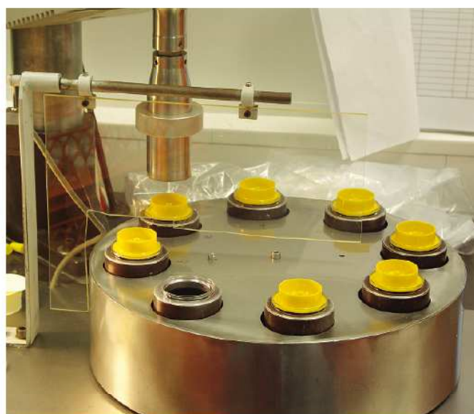
Bild 1 Detailaufnahme einer handbestückten Ultraschweißmaschine mit einer Plexiglasabschirmung zur Verringerung der Ultraschallbelastung am zugehörigen Arbeitsplatz.
