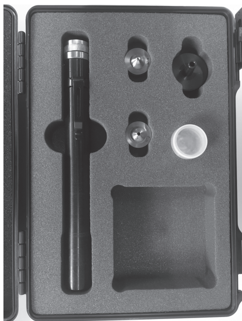
Bild 1. GGP-Mini als Komplettsystem für die Probenahme von Dampf-Tröpfchen-Gemischen.
