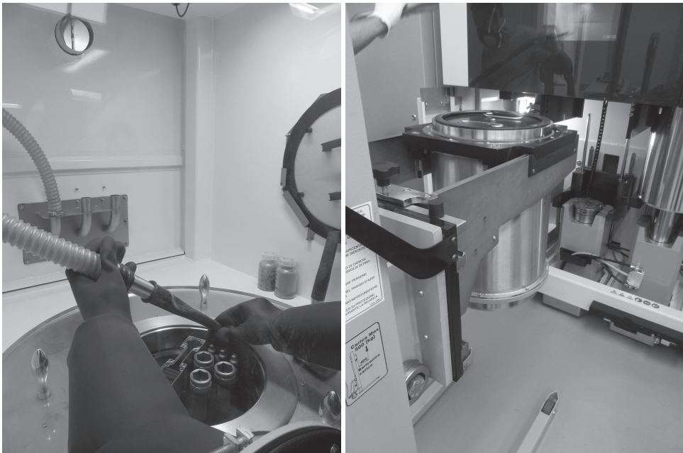
Bild 4. Links: Reinigung des Handhabungsraums einer selektiven Laserstrahlschmelzanlage mit einem Industriesauger; rechts: Bauraum, der mithilfe einer Hebevorrichtung der Anlage entnommen wird.
