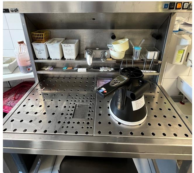
Bild 1. Flügelradanemometer Testo Typ 417 mit Messtrichter Ø 200 mm auf einem Lochblechtisch in einer Pathologie. Foto: Autoren
