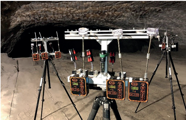
Bild 11. Aufbau der Versuchsreihe mit Tiefen- und Planfiltern. Grafik: Fa. K+S
