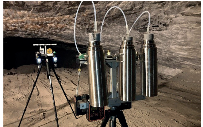
Bild 12. Aufbau der Versuchsreihe mit gekühlten Impingern. Grafik: Fa. K+S
