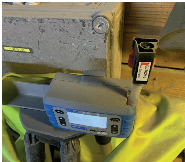
Bild 6. Fa. K+S-Probenahme mit Probenahmepumpe und ThermoSorb-N-Kartusche. Foto: K+S
