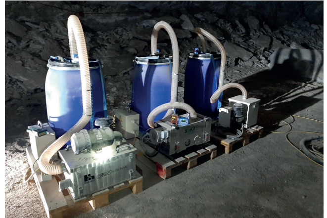
Bild 9. Versuchsreihe zur Eignung und Standzeit modifizierter Überdruckbelüftungsanlagen. Grafik: Fa. K+S
