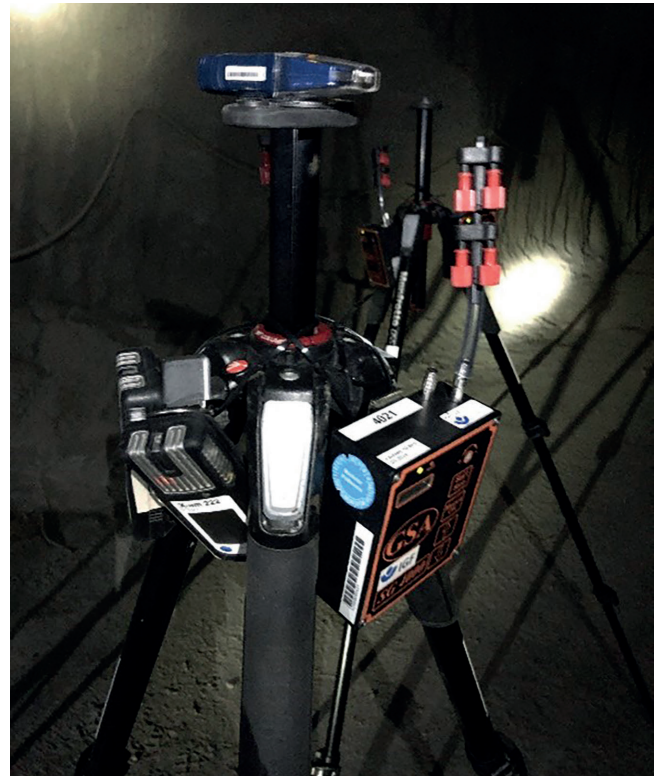
Bild 3. IGF-Probenahme mit PDS und ThermoSorb-N-Kartuschen. Foto: IGF
