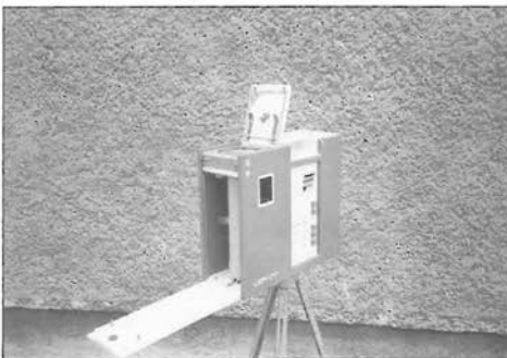
Abbildung 2: SPG 210 mit aufgeklappten Kammern für Feinstaubkassette und Zyklon
