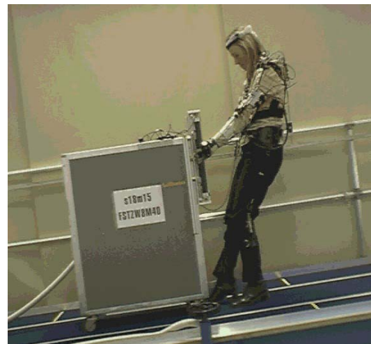
Abbildung 4-7: Probandin beim Schieben und Ziehen des Trolleys über eine schiefe Ebene (Laboruntersuchungen des BIA 2002)
