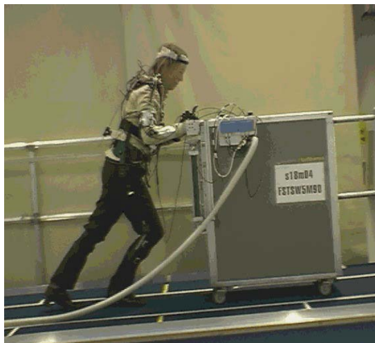
Abbildung 4-7: Probandin beim Schieben und Ziehen des Trolleys über eine schiefe Ebene (Laboruntersuchungen des BIA 2002)
