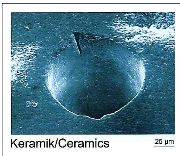
Abbildung 5: Präzisionsbearbeitung von Keramik mit Kupferdampfaser
