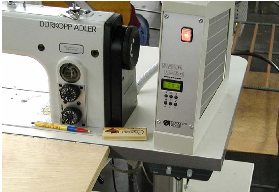
Abbildung 58: Ergonomisch optimierte Anordnung der Informationsaufnahme- und Bedienelemente
