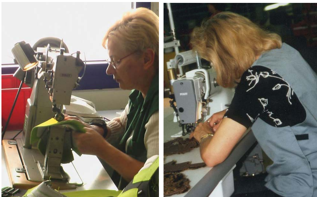
Abbildung 51: Hand- und Armhaltung an Säulen- (links) und Flachbettmaschine (rechts)
