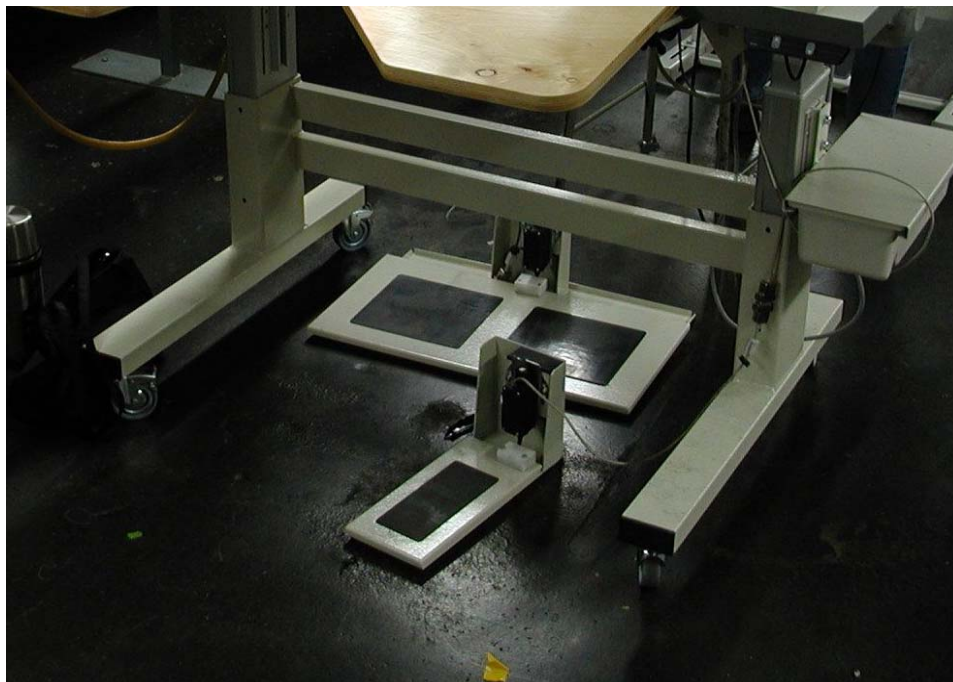
Abbildung 53: Frei im Raum positionierbare Fußpedale für sitzende und stehende Betätigung
