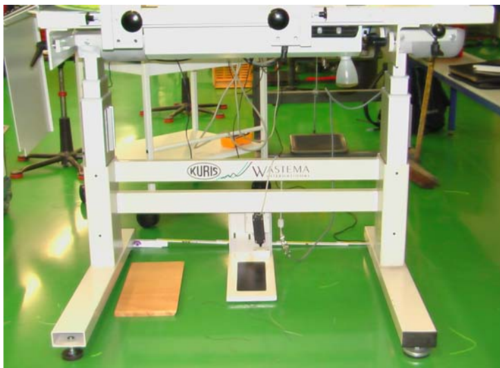
Abbildung 54: Höhenverstellmechanismus des Arbeitstisches
