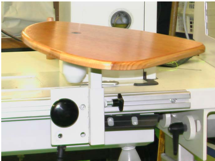
Abbildung 57: Armabstützung bei Säulenmaschinen
