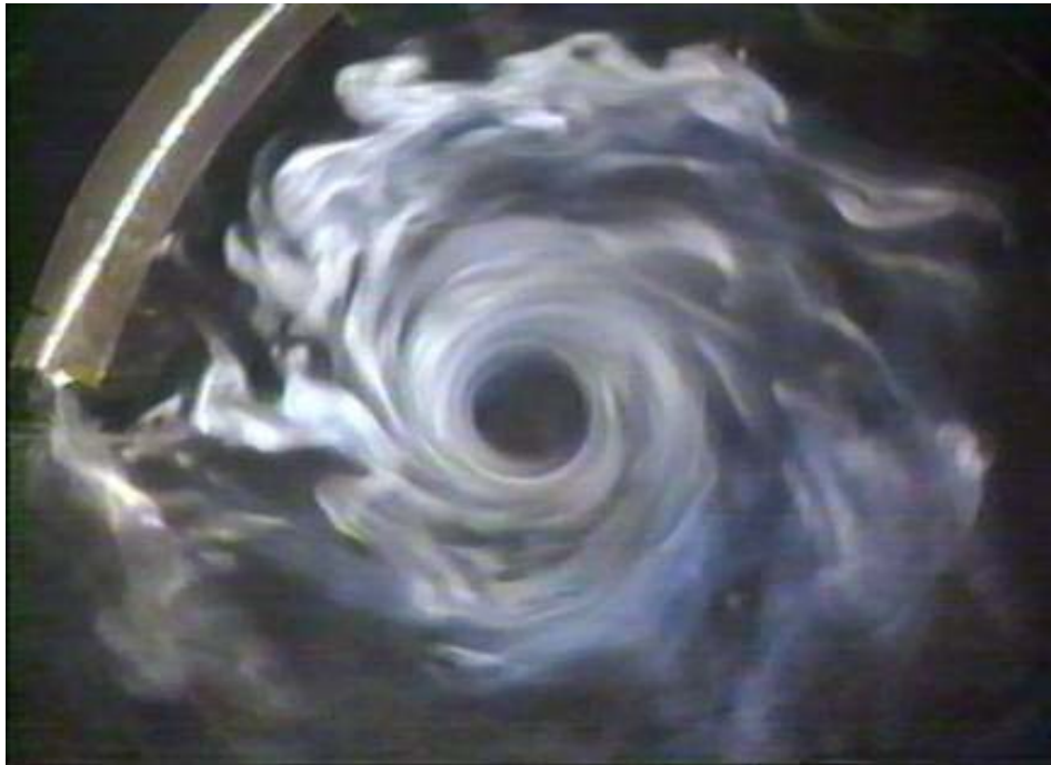
Abbildung 14: Strömungsfeld in einer Drallhaube
