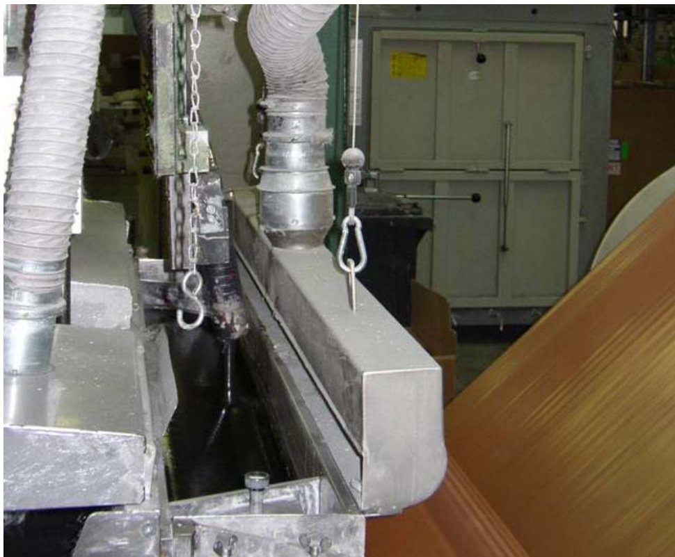
Abbildung 8: ROM-Drall®-Hauben zur Erfassung von Emissionen an Rakelkästen
