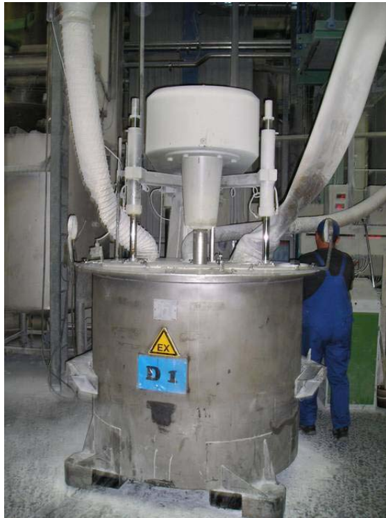
Abbildung 9: Optimierte Erfassung an den Rührbottichen
