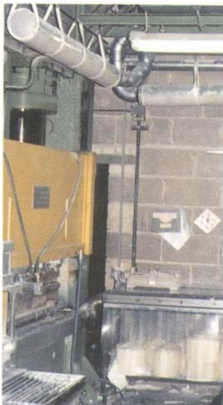
Abbildung 4: SMC-Presse und Zuschneidetisch
