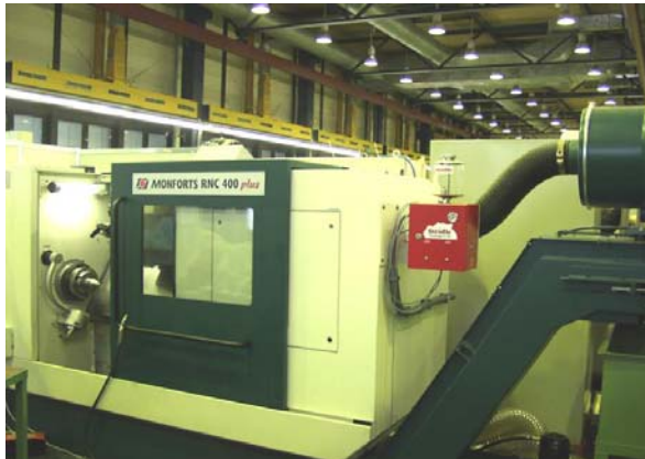
Abbildung 5: Drehmaschine mit Gerät für die Minimalmengenschmierung
