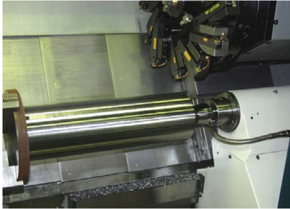
Abbildung 4: Arbeitsraum der Drehmaschine mit Welle und Zerspanwerkzeugen
