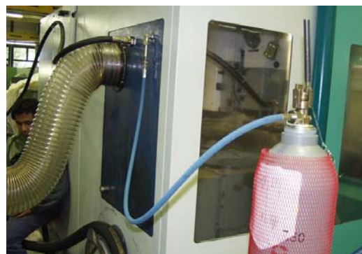
Abbildung 6: Druckentlastungskappen (links) und Löscheinrichtung mit 30 Liter Löschgas (rechts)
