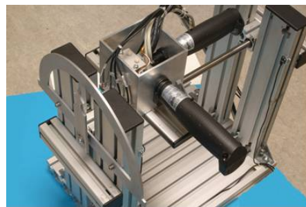
Abbildung 5: Prüfanordnung; HLG-Funktionsträger montiert auf einer Drehachse
