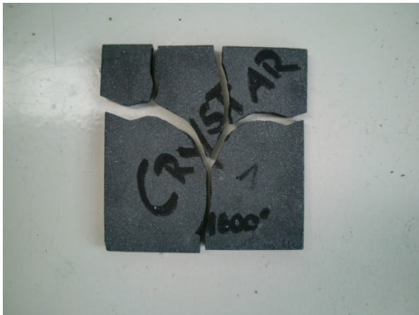
Abbildung 1: Technische Keramik nach Beschussversuch; Material: Crystar® 2000 (RSiC); Dicke: 1 cm; üblicher Einsatzort: Brennöfen; Einsatz freigegeben bis 1600 °C; Laserleistung: 1 kW; Bestrahlung im Fokus; d_F = 600 \mu\text{m} ; Standzeit: zersprungen nach 13 s;
