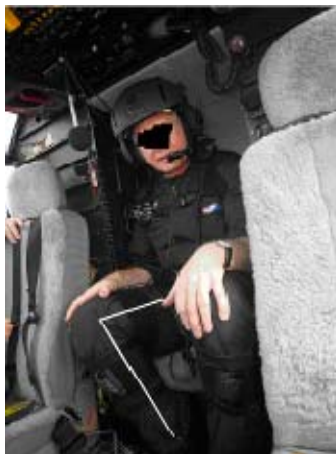
Bild 8: Sitzhaltung des Beschäftigten beim Technikerplatz der AS 332 L1 (Kniewinkel ist nachgezeichnet)
