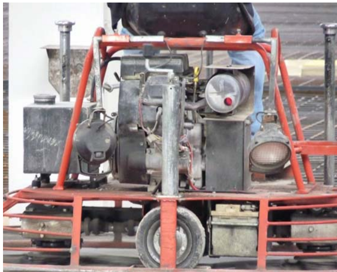
Benzinbetriebe Glättmaschinen mit Katalysator
