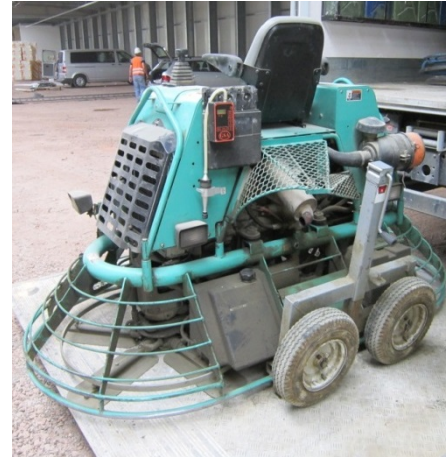
Dieselbetriebe Glättmaschinen mit Partikelfilter
