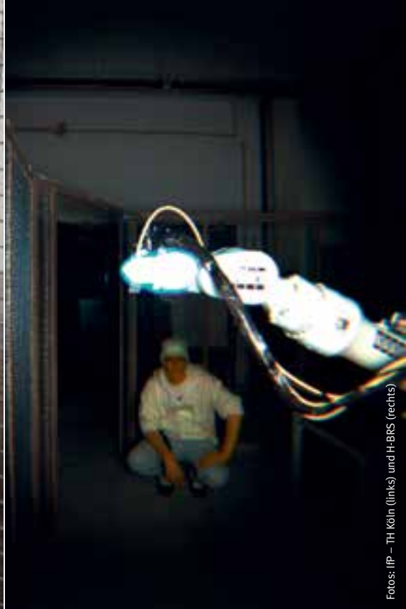
Abbildung 2: Feldtest des Detektionssystems mit einem Industrieroboter. Im Hintergrund des linken Bildes ist das aktive Nahinfrarotkameranaher zu erkennen.
