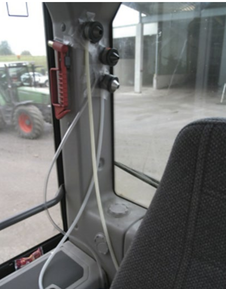
Abb. 1: Luftstaubsammlung in der Fahrerkabine eines Radladers. Die drei Probenahmeköpfe, die über jeweils einen Schlauch mit den entsprechenden Probenahmepumpen verbunden sind, wurden in der Atemhöhe des Fahrers positioniert.
