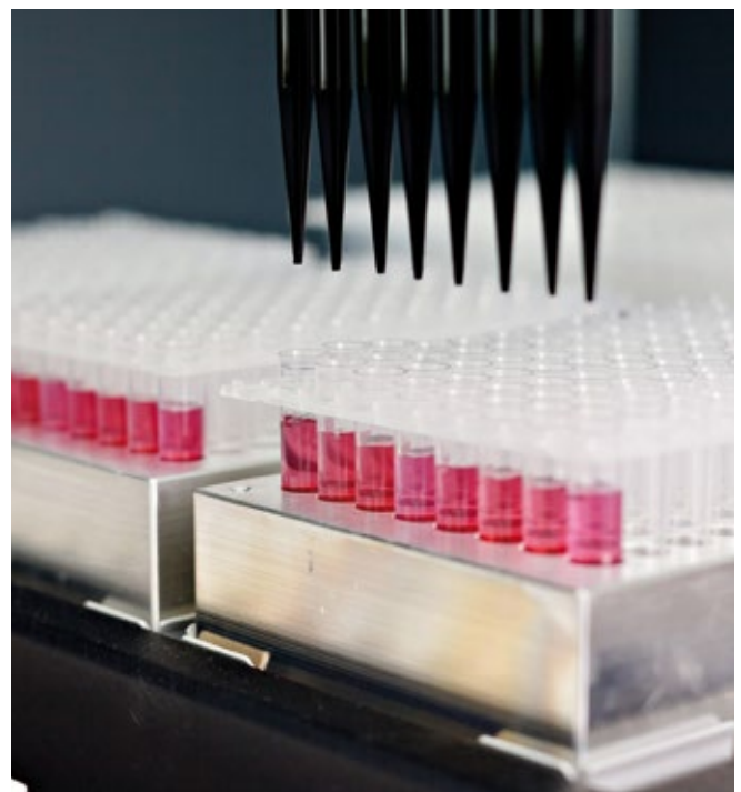
Die Aufteilung großer Probenmengen kann nicht mehr manuell verarbeitet werden, sondern erfordert ein Robotersystem. Hier erfolgt die Aufteilung in kleine, sogenannte Aliquots unter qualitätsgesicherten reproduzierbaren Bedingungen.
