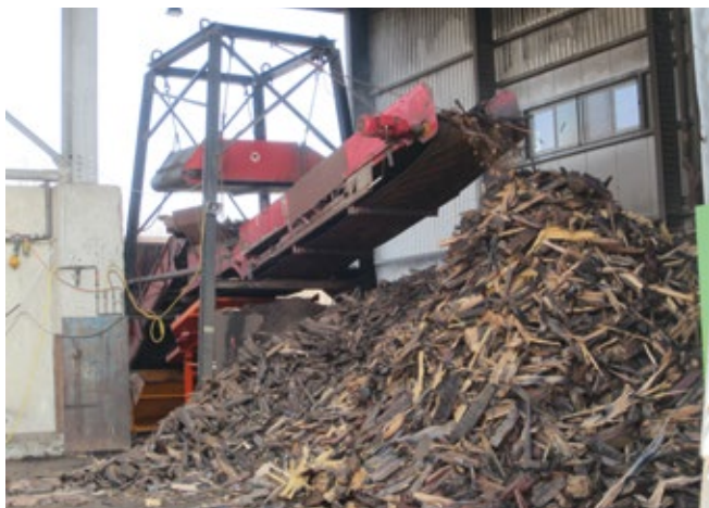
Schreddern von Bahnschwellen
