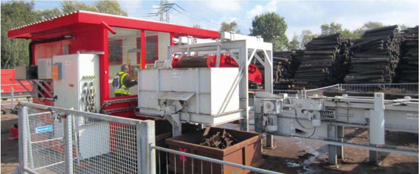
Bahnschwellen-Abplattanlage mit schutzbelüfteter Kabine
