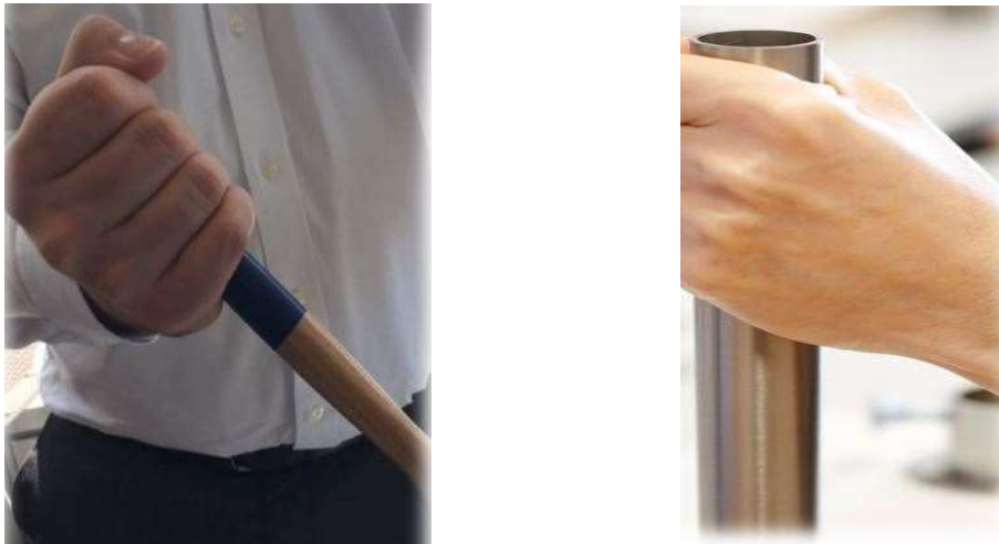
Abbildung 4: Prüfung der Rutschfestigkeit mit Holzhammerstange und Metallstange
