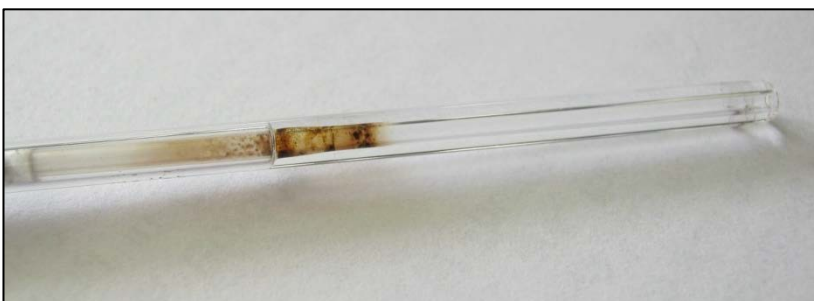
Abbildung 4-1: Rückstände in der Kühlfalle bei zu geringem Split
