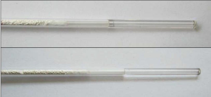
Abbildung 4-2: Neue Falle zu Beginn der Messreihe (oben) und Falle nach der Durchführung von 63 Thermodesorptionen.
