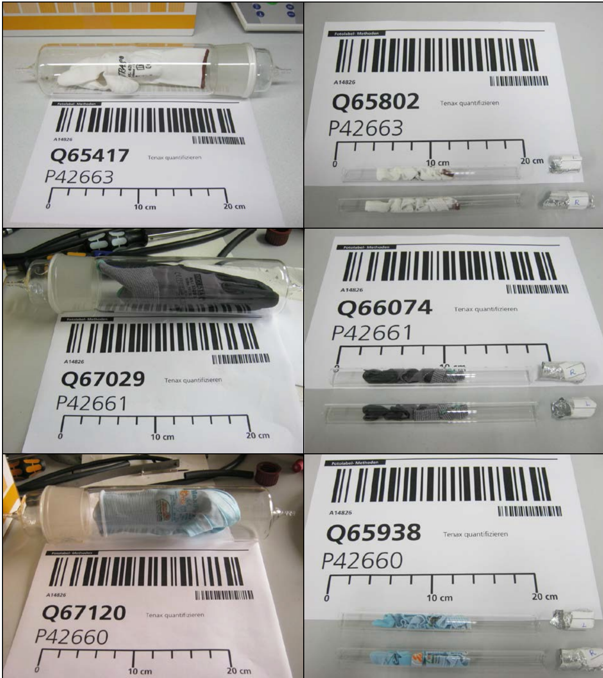
Abbildung 4-15: Proben im Extraktionsgefäß für die Extraktion des gesamten Handschuhs (links) und die Extraktion nach Zuschnitt (rechts).
