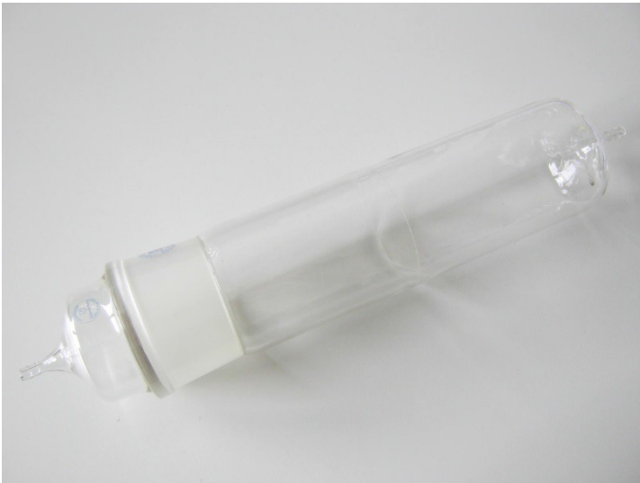
Abbildung 3-5: Glasrohr für die thermische Extraktion eines Handschuhs
