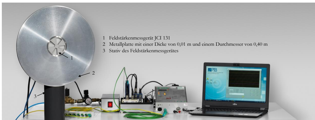
Abbildung 4.4: Aufbau der Feldstärkenmessung für Messungen an Strahlen und Sprühnebeln, ohne die räumliche Begrenzung eines Behälters
