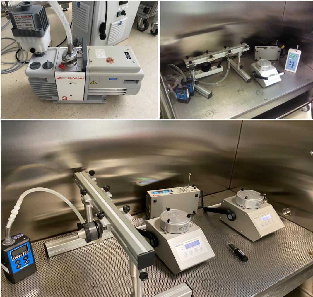
Abbildung 7 – Aufbau in der Testebene der Bioaerosolkammer mit Kontrollgeräten - Partikelzähler 11-C und Datalogger zur Aufzeichnung von Lufttemperatur und -feuchte; oben - Aufbau 1 mit zwei Filtersystemen und einem MBASS30, optional zwei Gilian 10i Pumpen oder eine RV3 (links), die Sammlung erfolgte sequenziell (unterschiedliche Dauer, gleiches Sammelvolumen); unten – Aufbau 2 mit einer Filtrationseinheit und zwei MBASS30, die Sammlung erfolgte gleichzeitig (gleiche Dauer unterschiedliches Sammelvolumen)
