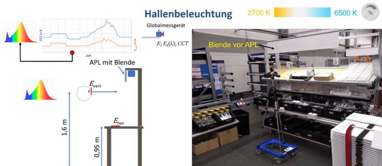
Abbildung 4. links: Skizze der Messgeometrie für Größen, die auf vertikaler ( E_{\text{vert}} ) und horizontaler ( E_{\text{hor}} ) Ebene am Montagearbeitsplatz mit Arbeitsplatzbeleuchtung (APL) gemessen werden. rechts: Zeitgleich erfolgte Spektralmessungen am Globalmessplatz und Messungen am realen Arbeitsplatz. Dieser Arbeitsplatz wurde als Referenzmessplatz gewählt. Gezeigt ist die modifizierte APL, die mit einer Blende zur Kontrolle der Lichtabstrahlung versehen wurde.
