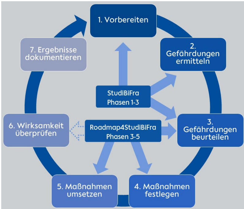
Abbildung 10: Prozessschritte der Gefährdungsbeurteilung und deren Berücksichtigung im Projekt „StudiBiFra“ sowie im beantragten Folgeprojekt „Roadmap4StudiBiFra“
