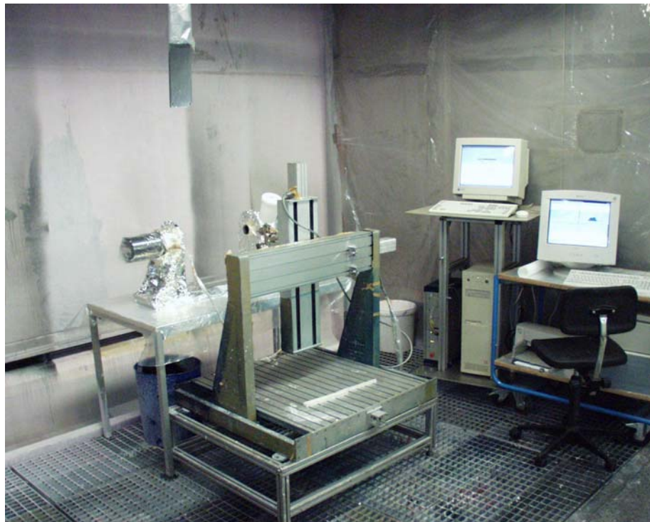
Abb. 2: Spritzstand mit Traversierung, Messgerät sowie Steuerungs- und Messrechner
